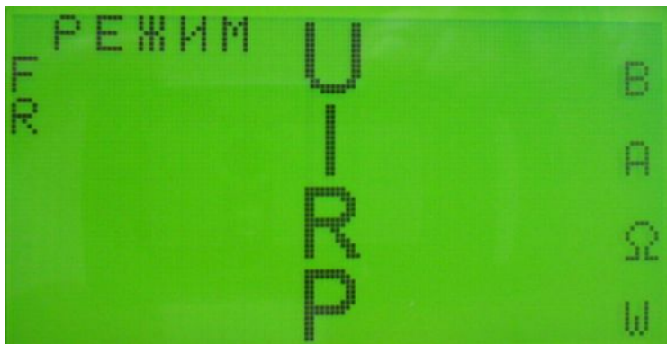
рис.16. Вид дисплея ПДУ IFL-55106: генератор не готов к работе
