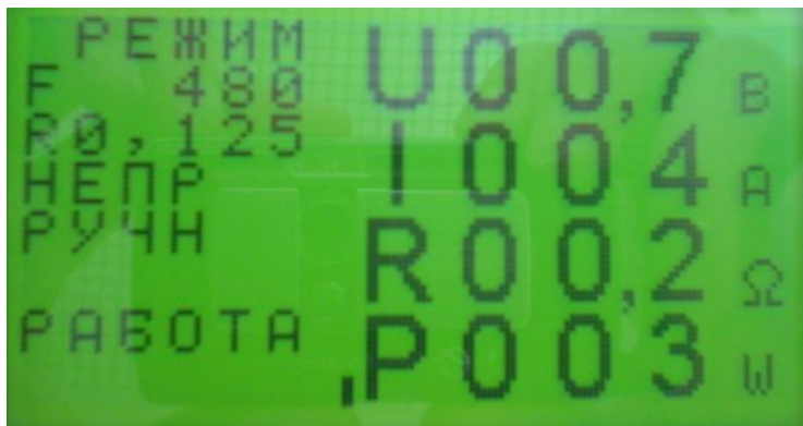
рис. 17. Вид дисплея ПДУ IFL-55106: ручной режим согласования
