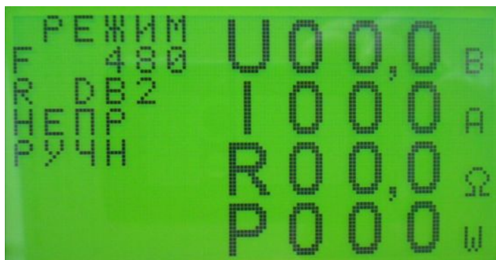
рис. 15. Вид дисплея ПДУ IFL-55106: генератор готов к работе
