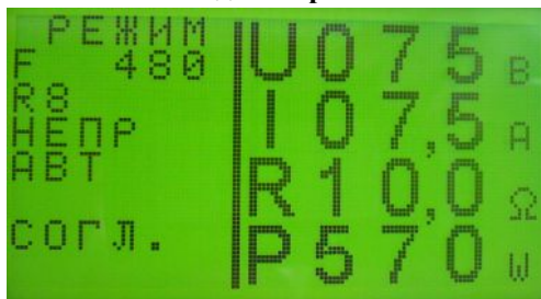
Рис 18. Вид дисплея ПДУ IFL-55106: автоматический режим согласования
