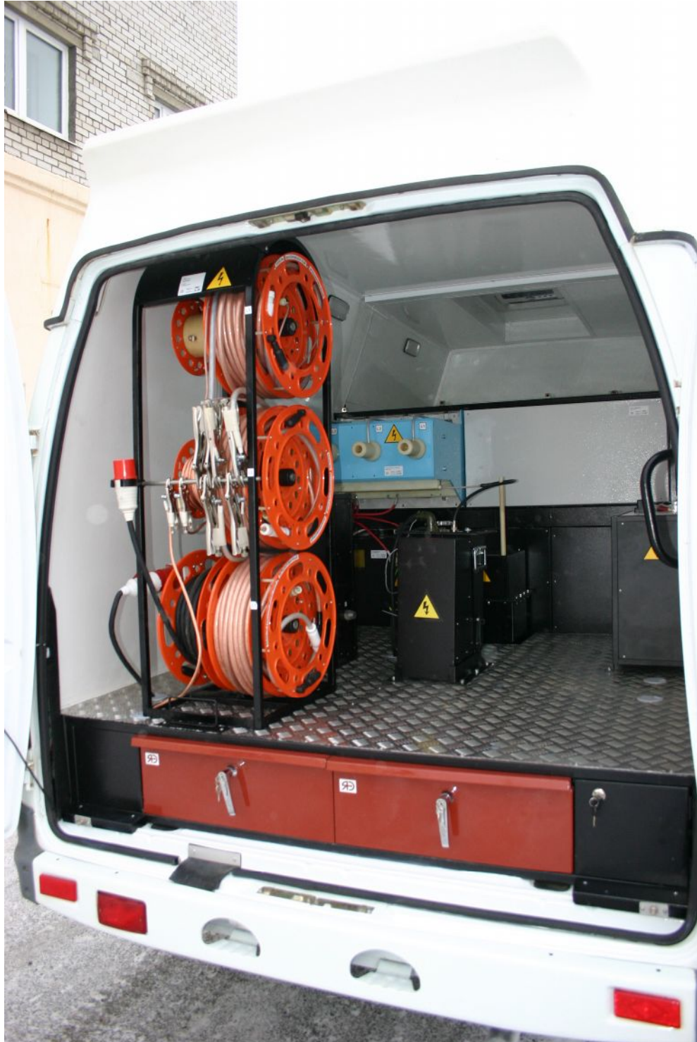
Вид на высоковольтный отсек кабельной лаборатории ЛВИ НVT-25FVG
