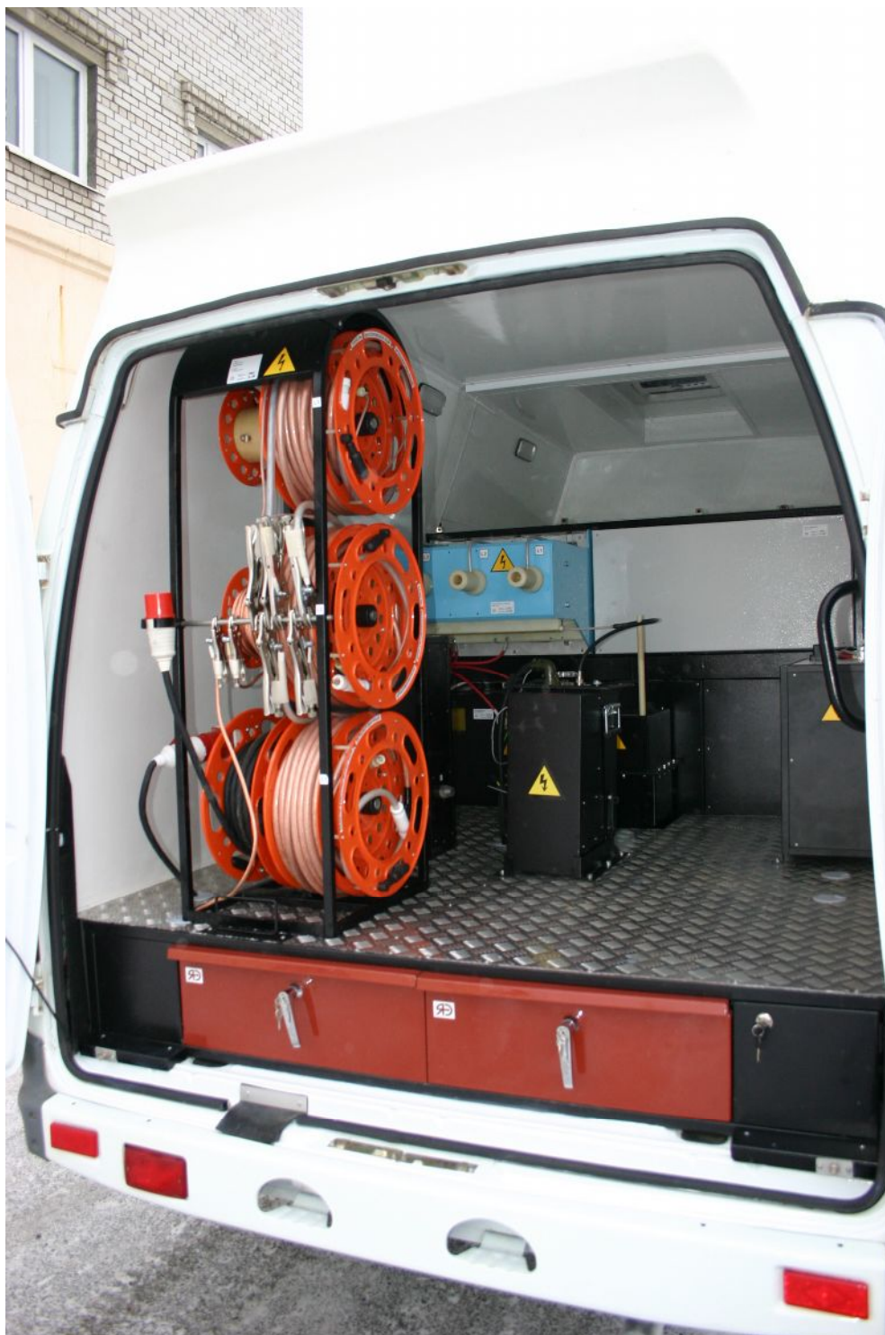
Вид на высоковольтный отсек кабельной лаборатории ЛВИ НVT-10FG
