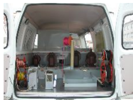
Схема расположения оборудования в лаборатории ЛПИТ -10 (лаборатория на шасси ГАЗ, КАМАЗ, слева и лаборатории на в автомобиле типа «Газель», справа)
