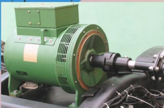
Система предназначена для автоматического поддержания частоты вращения дизельного двигателя и привода синхронного генератора. Постоянная частота напряжения генератора обеспечивается посредством воздействия на рычаг управления топливного насоса двигателя через пневмоцилиндр.
